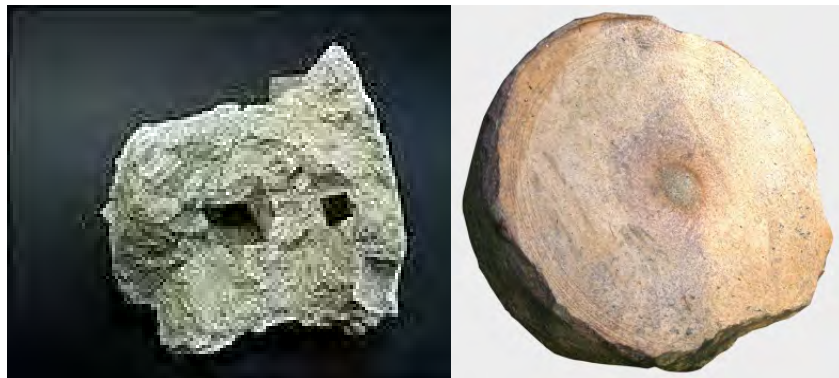
Obr. 2 Mlecí kámen využívaný na mletí kyzových výpalků a kyz železný v surovém stavu.
